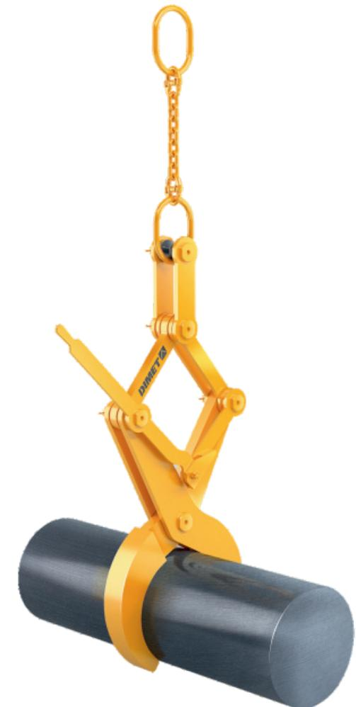
Данный тип клещевых захватов предназначен для транспортировку круглой заготовки, труб. Мы разработали серию клещевых захватов в данном конструктиве способную транспортировать груз массой 5, 9, 13,5, 15 т. Захваты оснащены автоматической защелкой, которая позволяет исключить нахождение человека в опасной зоне проведения погрузо-разгрузочных работ.
