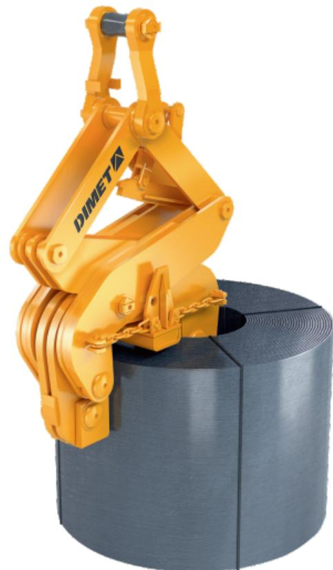
Захват предназначен для подъема и перемещения рулона стали в вертикальном положении. Одной из особенностей является способность захвата транспортировать 2 рулона. В верхней части захвата имеется проушина для установки на крюк крана, захват оснащен автоматической защелкой. Для защиты торцевой поверхности рулона на захвате установлена защитная площадка.
