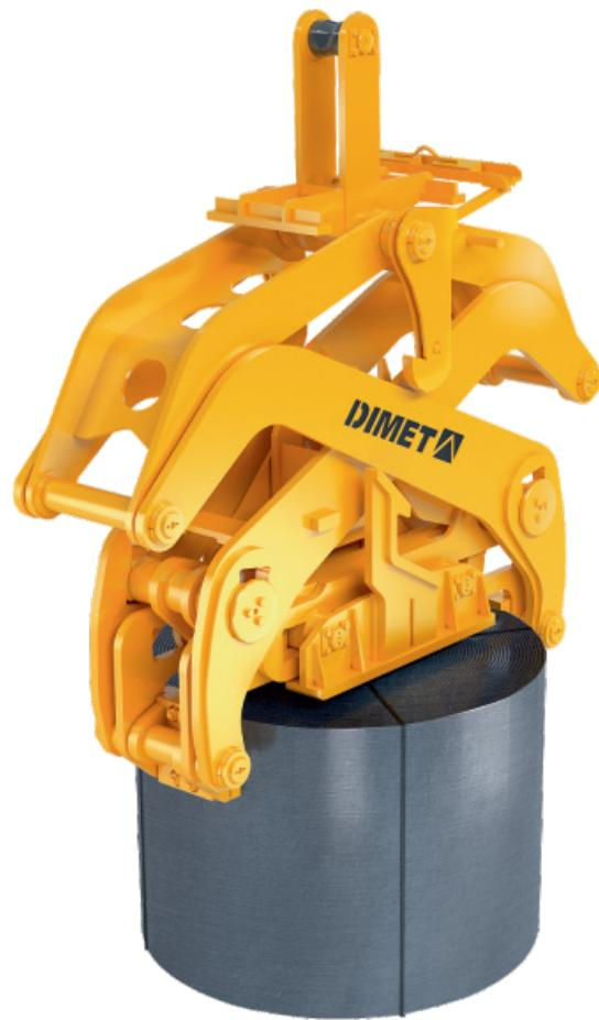
Захват предназначен для подъема и перемещения рулона стали в строго вертикальном положении. Захват груза производится за внутреннюю и наружную часть одновременно с противоположных сторон. В верхней части захвата имеется проушина для установки на крюк крана, захват оснащен автоматической защелкой. Металлоконструкция захвата выполнена из низколегированной конструкционной стали 10ХСНД. Оси захвата – конструкционной легированной стали 40ХН2МА.
