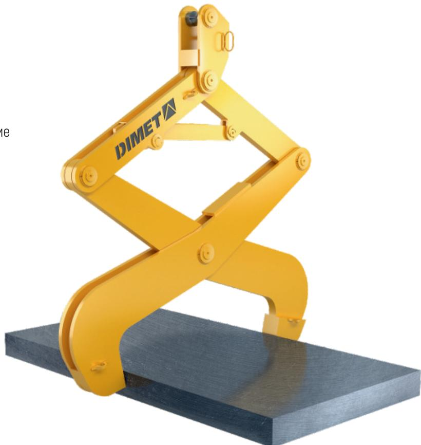
Данный тип клещевых захватов предназначен для транспортировки слябов. Мы разработали серию клещевых захватов в данном конструктиве способную транспортировать груз массой 13,5, 15, 20 т. Захваты оснащены автоматической защелкой, которая позволяет исключить нахождение человека в опасной зоне проведения погрузо-разгрузочных работ. Захват предназначен для работы с грузом температура которого составляет не более 750 °C.
